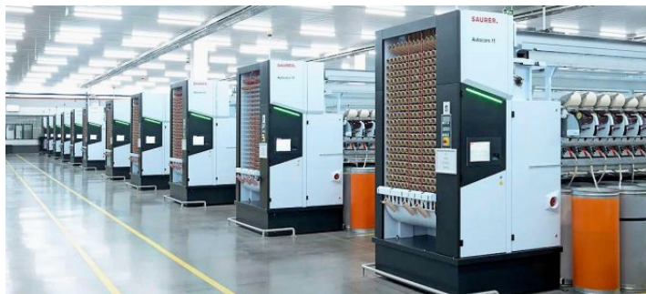
Autocoro-11-Rotorspinnmaschinen der vierten Generation von Saurer.
